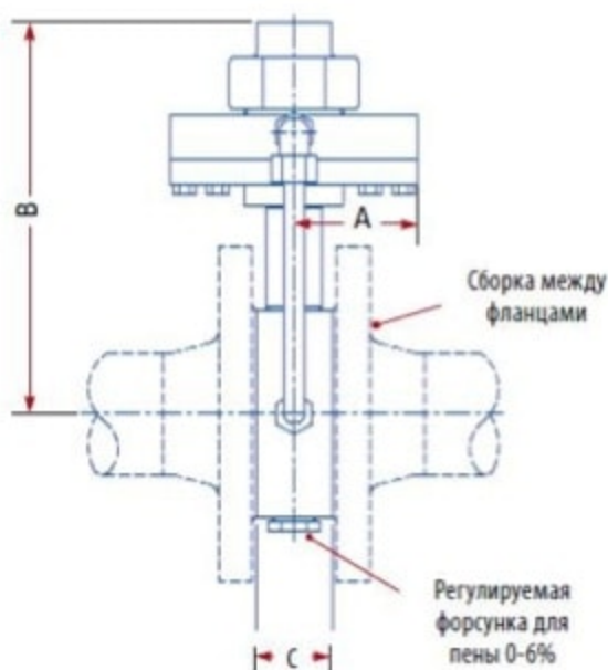
Рис.2 Дозаторы PP и PPW. Способ установки и габаритные размеры изделий
